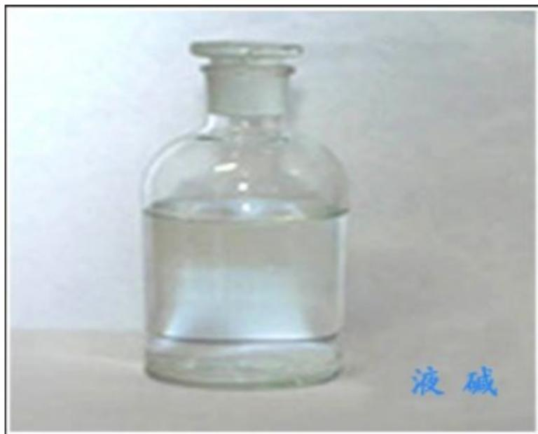
离子交换膜法：将原盐化盐后按传统的办法进行盐水精制，把一次精盐水经微孔烧结碳素管式过滤器进行过滤后，再经螯合离子交换树脂塔进行二次精制，使盐水中钙、镁含量降到0.002%以下，将二次精制盐水电解，于阳极室生成氯气，阳极室盐水中的 $\text{Na}^+$ 通过离子膜进入阴极室与阴极室的 $\text{OH}^-$ 生成氢氧化钠 $\text{NaOH}$ 直接在阴极上放电生成氢气。电解过程中向阳极室加入适量的高纯度盐酸以中和返迁的 $\text{OH}^-$ ，阴极室中应加入所需纯水。在阴极室生成的高纯烧碱浓度为30%~32%(质量)，可以直接作为液碱产品，也可以进一步熬浓，制得固体烧碱成品。苏州精制液碱液碱是什么东西提炼出来的？欢迎咨询无锡市安尼可化工有限公司。
